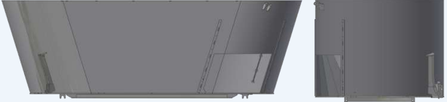
Pente 107° avant et arrière & 90° sur les côtés
